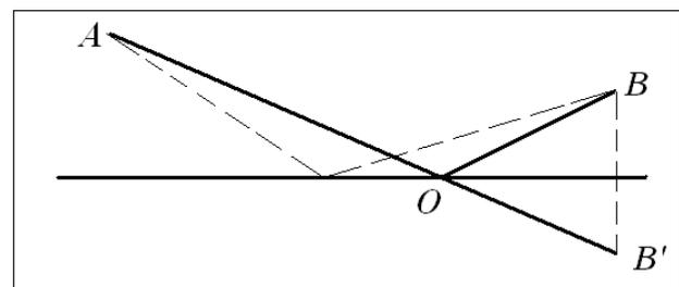
Рис. 3. Угол падения равен углу отражения
